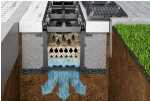
Rigole d'infiltration avec substrat (© Funke Kunststoffe)
