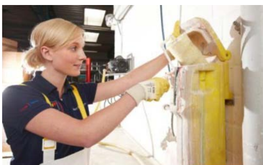
Appareil de lavage des rouleaux de peinture avec avec collecte et traitement séparés des eaux usées Photo : © Bundesverband Farbe Gestaltung Bautenschutz
