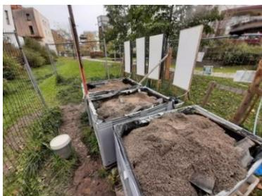
Um die Biozidauswaschung aus Fassaden und deren Verlagerung im Boden genauer untersuchen zu können, wurden in dem Wohnviertel zusätzlich künstliche Wände und Bodenkörper, sogenannte Lysimeter, errichtet. Nach dem Ende der Experimente wurde das Material der Lysimeter ausgegraben und Teile davon für weitere Analysen ins Labor gebracht. Dort wurden die an den Bodenteilchen hängenden, „adsorbierten“, Biozide und deren Transformationsprodukte extrahiert und gemessen. Die Menge der zurückgehaltenen
