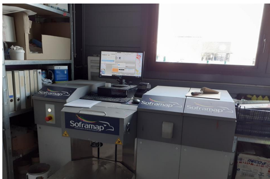
La machine à teinter « Soframap » dans les ateliers de Déco 6. La machine sert à teinter des petites unités, pour dépanner les clients. Il dispose d’une autre de la marque Caparol. On ne peut pas utiliser l’outil SOFRAMAP pour teinter une peinture Caparol
