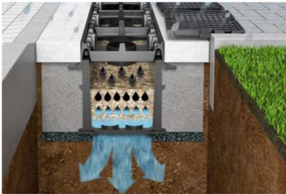
Rigole d'infiltration avec substrat (© Funke Kunststoffe)
