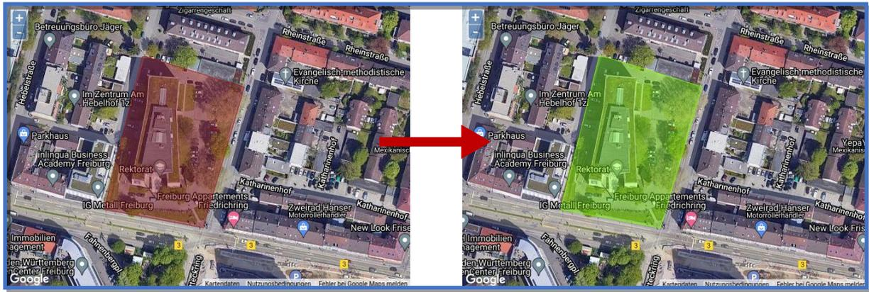
Figure 5 Dessiner la surface de base par des clics de souris et confirmer par un double clic (la couleur de la surface passe du rouge au vert).
