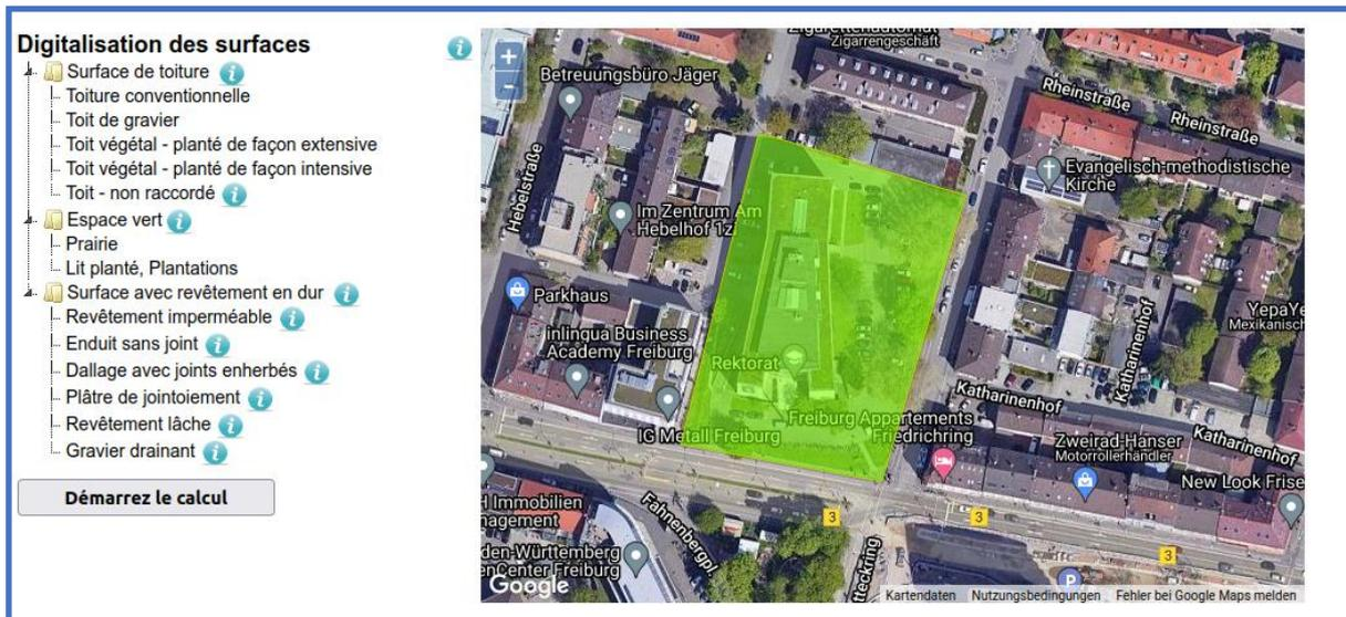
Figure 7 Sélection des types de surfaces.
